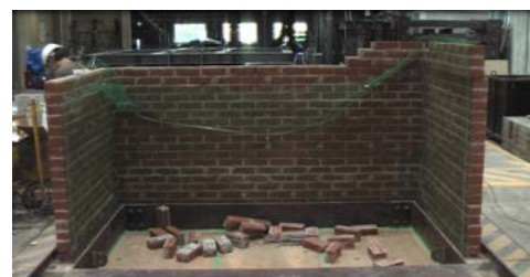
写真 3 金網補強の試験体(実験終了後)
