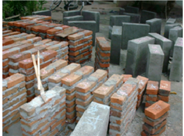
图7 建研专家制作的测试体 2006 印度尼西亚
