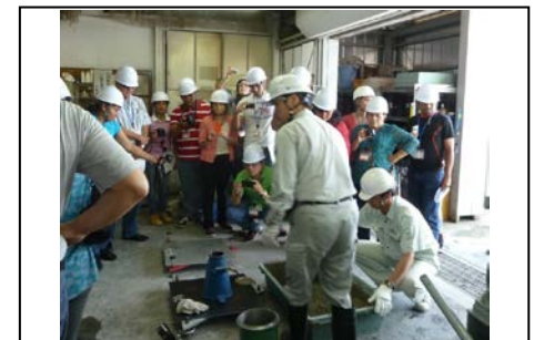
写真3 コンクリート製造工場の見学 (コンクリートのスランプ試験)
