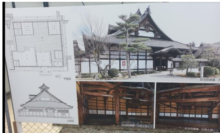
京都・妙法院庫裏の平面図と木造構造
