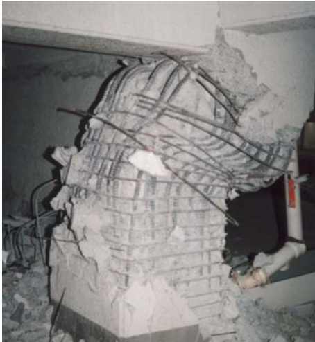
写真 2.1 : 1995 年兵庫県南部地震で曲げ圧縮破壊した柱。外周に 100 mm 間隔の帯筋で拘束。
