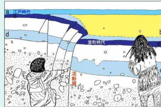
真上断層のトレンチ調査。a: 近世の耕作土の床土、b: 断層活動の後で運んだ盛土、 c: 鎌倉～室町時代の耕作土、d: 奈良～平安時代の耕作土
