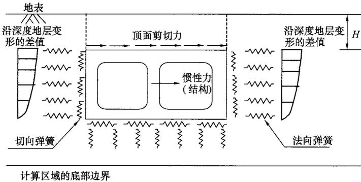
图 30 反应位移法的等效荷载
