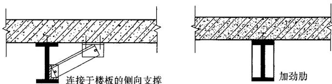
图 22 钢梁受压翼缘侧向约束
