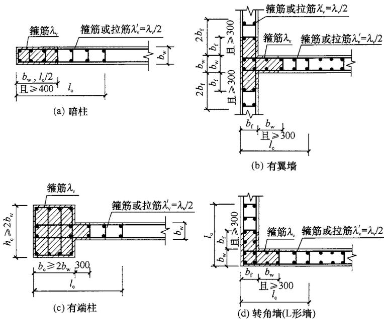
图 6.4.5-2 抗震墙的约束边缘构件
