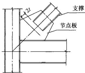
图 25 支撑端部节点板的构造示意图
