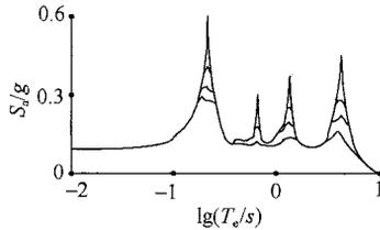
图 29 长富宫顶层的楼面反应谱
