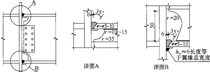
图 8.3.4-1 框架梁与柱的现场连接
