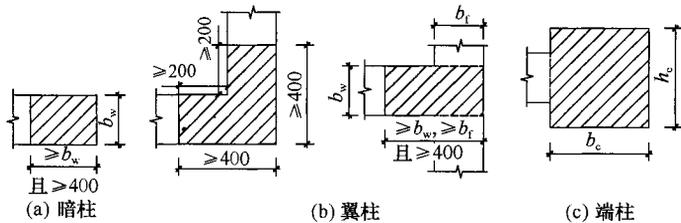
图 6.4.5-1 抗震墙的构造边缘构件范围
