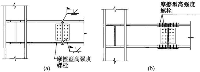
图 8.3.4-2 框架柱与梁悬臂段的连接
