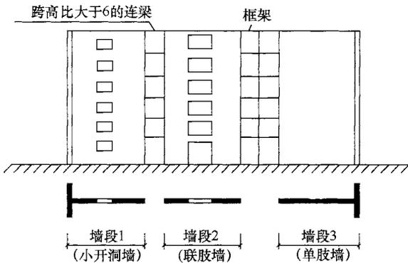
图 14 较长抗震墙的组成示意图
