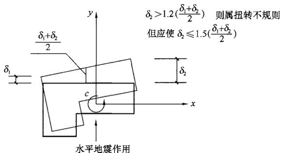
图 1 建筑结构平面的扭转不规则示例
