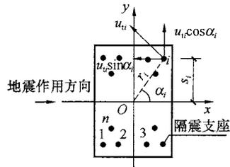
图 27 隔震层扭转计算简图
