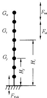
图 5.3.1 结构竖向地震作用计算简图
