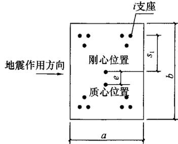
图 L. 1. 4 扭转计算示意图
