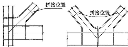
图 21 支撑端部刚接构造示意图
