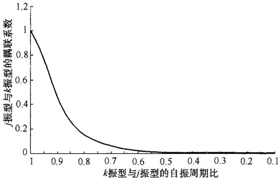
图 10 不同振型周期比对应的耦联系数
