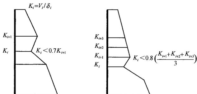
图4 沿竖向的侧向刚度不规则（有软弱层）
