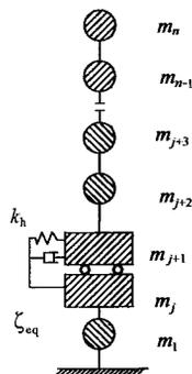
图 12.2.2 隔震结构计算简图
