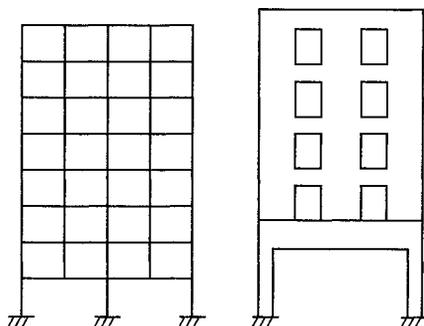
图5 竖向抗侧力构件不连续示例
