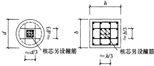
图 16 芯柱尺寸示意图
