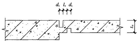
缝宽  $d_s$  大于 5mm；两缝间距  $l_s$  大于 50mm
